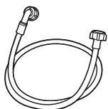
Шланг подачи холодной воды
