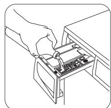
Вытяните до упора дозатор моющих средств. Отмерьте нужное количество моющего средства, засыпьте его в отделение основной стирки дозатора и, если Вы желаете выполнить предварительную стирку или замачивание, засыпьте его в отделение, помеченное символом .
