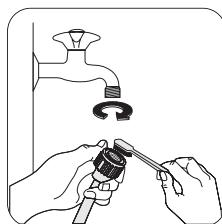
Закройте кран подачи воды. Открутите наливной шланг. Прочистите фильтр жесткой щеткой. Прикрутите на место наливной шланг.
