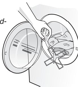
Lehkým zatlačením zavřete dvírka a poté zkontrolujte, zda mezi dvírkami a těsněním nezůstaly přiskřípnuté oděvy.
