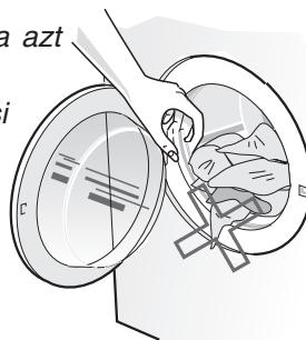
Enyhén megnyomva zárja be a készülék ajtaját, de ügyeljen arra, hogy az ajtó és a tömítés között ne maradjanak beszorult ruhadarabok.
