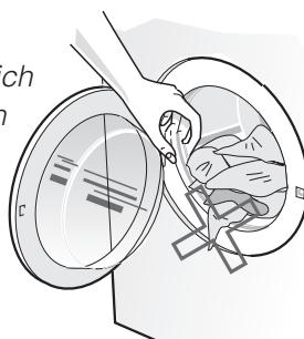
Das Einfüllfenster mit leichtem Druck schließen und dabei darauf achten, dass keine Wäschestücke eingeklemmt werden.
