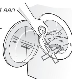
Sluit de wasmachinedeur met een lichte druk en controleer of er geen kledingstukken tussen het deurtje en de pakking klem zitten.
