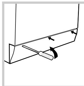
3. снимите нижний плинтус стиральной машины при помощи отвертки (*см. рисунок*).
