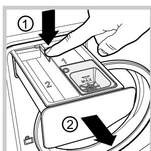
Чтобы вынуть дозатор, нажмите на язычок (1) и вытащите дозатор (2) (см. рисунок). Промыть ячейку под струей воды. Эта операция должна выполняться.
