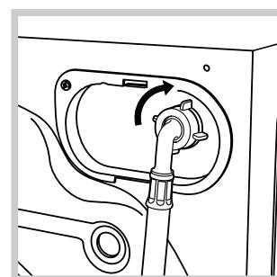
1. Подсоедините шланга к машине, привинтив его к специальному крану, расположенному в задней верхней части справа (см. рисунок).
