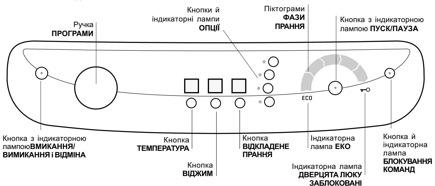
**Кнопка з індикаторною лампою Ⓛ ВМИКАННЯ, ВИМИКАННЯ і ВІДМІНА:** швидко натисніть і відпустіть кнопку для вмикання або вимикання машини. Зелена індикаторна лампа означає, що машина ввімкнена. Для вимикання пральної машини під час прання необхідно утримувати кнопку натиснуту приблизно більш ніж 2 сек.; короткочасне або випадкове натискання не дозволить вимкнути машину. Вимикання машини під час циклу прання анулює дане прання.
