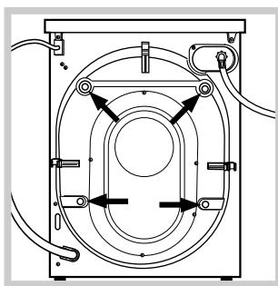
2. Снимите 4 винта, предохраняющие машину в процессе перевозки, и распорки, расположенные в задней части машины (см. рисунок).
