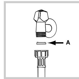
2. Вставьте прокладку A из пакета в конец водопроводного шланга и привинтите его к водопроводному крану холодной воды с резьбовым отверстием 3/4 gas (см. рисунок).
