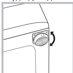
2. Ако подът не е идеално хоризонтален, компенсрайте неравностите, като отвиете или завийте предните крачета (виж фигураната); ъгълът на наклона, измерен върху работната повърхност, не трябва да надвишава 2°.
