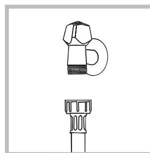
1. Conectați furtunul de alimentare, însurubându-l la un robinet de apă rece cu gura filetată de l'gaz (a se vedea figura).
