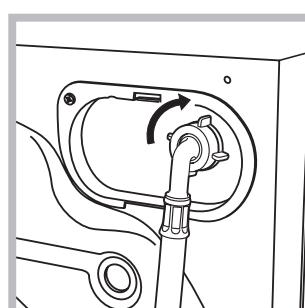
2. A vízbevezető cső csatlakoztatásához csavarozza a csövet a mosogép hátoldalán jobbra fent található vízbemeneti csonakra (lásd ábra).
